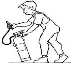
2. Asir la boquilla de la manguera del extintor y comprobar, en caso que exista, que la válvula o disco de seguridad (V) está en posición sin riesgo para el usuario. Sacar el pasador de seguridad tirando de su anilla.
